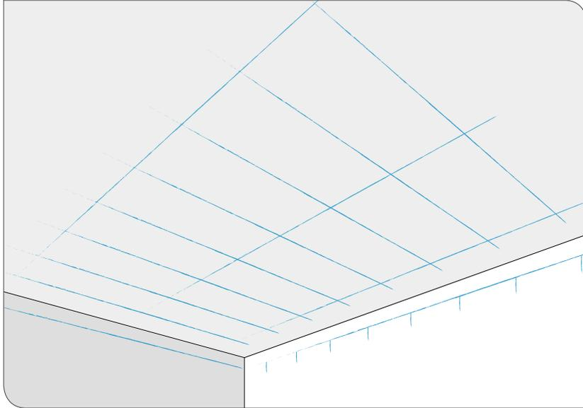
Traça-se o perímetro do teto, correspondente à parte baixa da estrutura. Depois traça-se o posicionamento da estrutura na laje. Continua-se a marcar o lugar exato dos apoios, respeitando as medidas de arranque e distância de apoios dependendo da composição do referido teto. Traçam-se os pontos críticos das instalações se for necessário.
